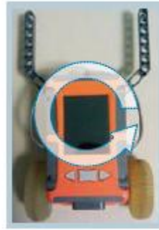
如图：机器人原地左转 右马达状态正确 左马达状态错误
