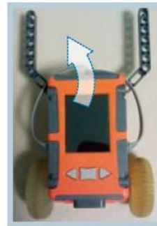
机器人向左偏离 马达实际执行速度： 左 < 右 解决办法： 将右马达速度稍微减少
