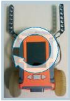
如图：机器人原地右转 左马达状态正确 右马达状态错误
