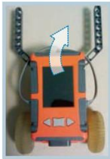
机器人向右偏离 马达实际执行速度： 左 > 右 解决办法： 将左马达速度稍微减少
